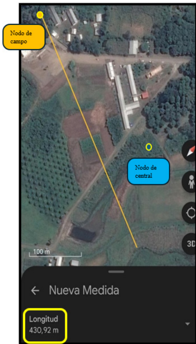
Figura 10. Cobertura de señal del Gateway.
